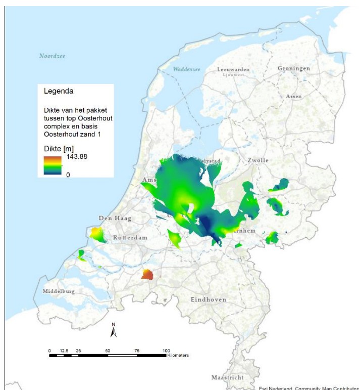
Figuur 1b. Dikte van het pakket tussen de basis van Oosterhout zand 1 en top Oosterhout complex. Er komen geen negatieve diktes voor, dit betekent dat de top van de Oosterhout complex niet hoger ligt dan de bovenliggende eenheid.
